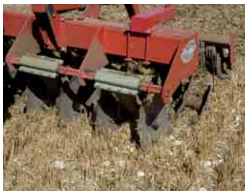
Déchaumage avec un outil à disques.
