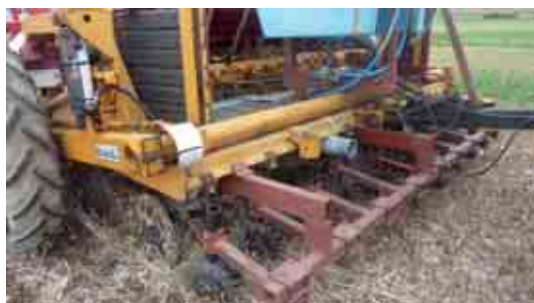
Présentation du travail du disque et du chasse-paille.
